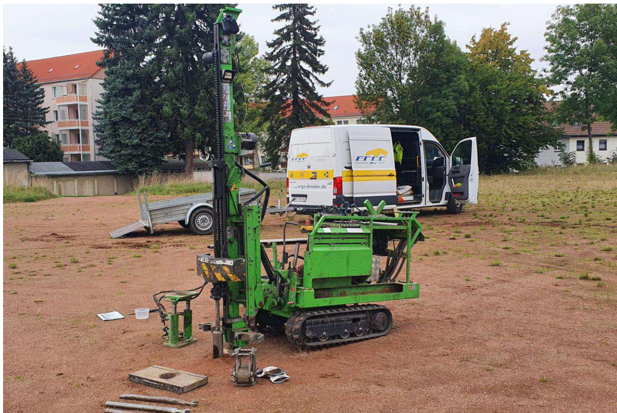
Abbildung 1 Bohrgerät zur Kleinrammbohrung
